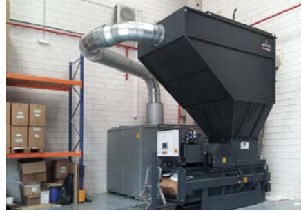
Anwendungsbeispiel: Absaug- und Zerkleinerungsanlage für fünf Stanzgittermaschinen inkl. einer Kanalballenpresse Lösung: Cuttopress CP-4000
