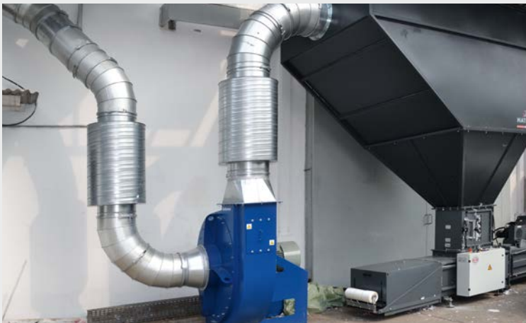
Anwendungsbeispiel: Absauganlage für zehn Produktionsmaschinen, inkl. Ballenpresse Lösung: Cuttopress CP-4000
